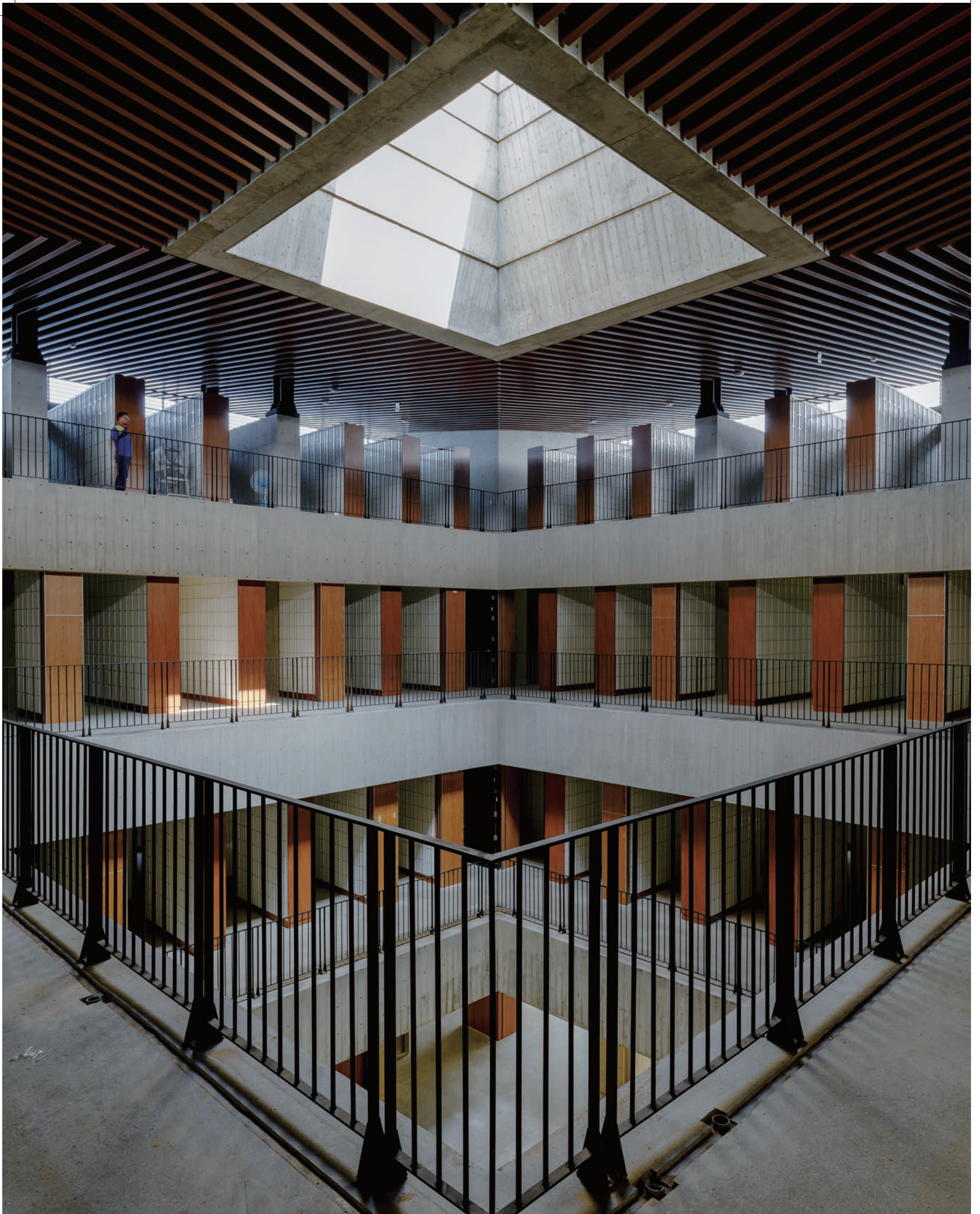
中央天井使得熱空氣上升、冷空氣下降，達成循環對流之無空調空間。
